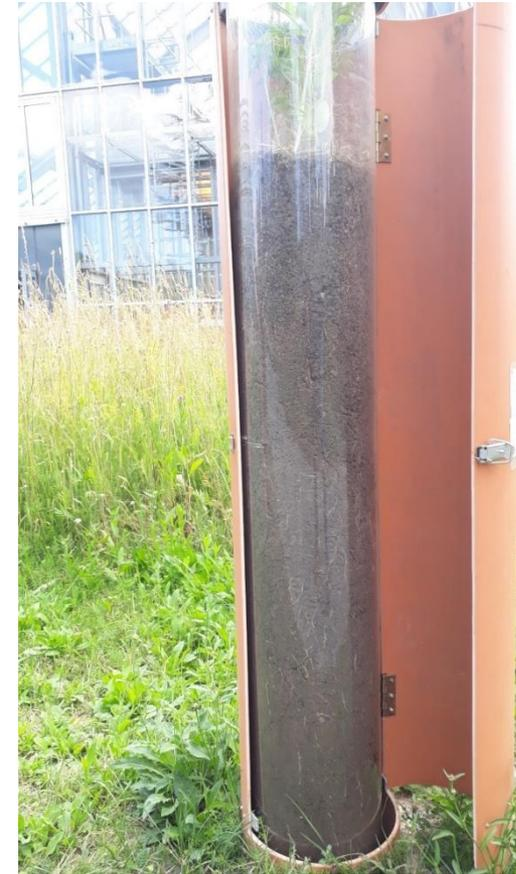
Abbildung 7 : Wasserinfiltration – Versuche Gegenüberstellung © Johannes Herold (GeoTeam 2022)
